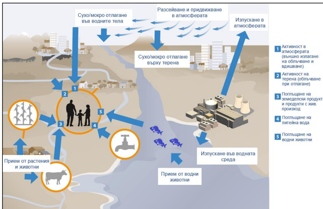
ФИГУРА 1: КОНЦЕПТУАЛЕН МОДЕЛ НА ESTE ГОДИШНИ ВЪЗДЕЙСТВИЯ: ПЪТИЩА НА ИЗЛАГАНЕ НА РАДИАЦИОННО ОБЛЪЧВАНЕ.
